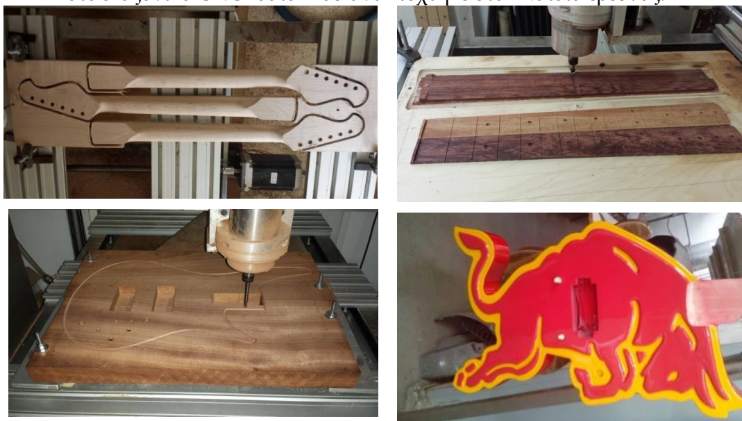
Εικόνα 7. Κατεργασία εξαρτημάτων μουσικών οργάνων στο 3-αξονικό CNC router που αναπτύχθηκε στα πλαίσια έρευνας.
